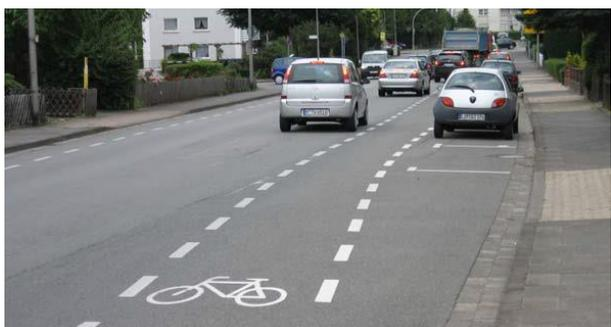
Fig. 4: Corsia ciclabile con sosta laterale
